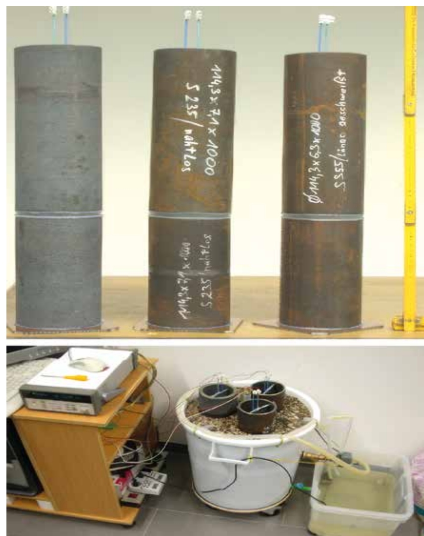
Рис.4. Образцы свай и тест на коррозионную активность.
